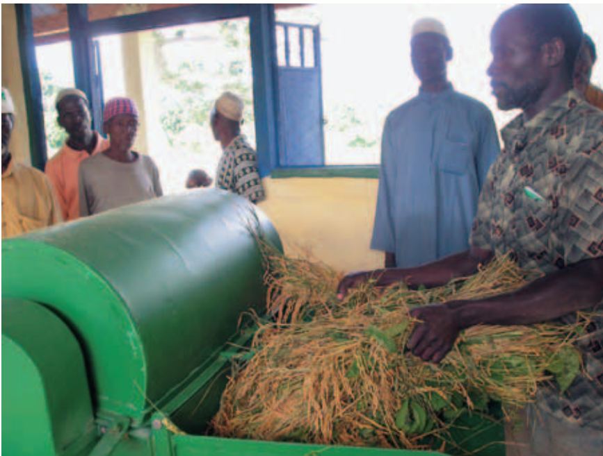
La batteuse de riz ASI adaptée aux conditions africaines par l'ADRAO et ses partenaires : un bonus pour les paysans
